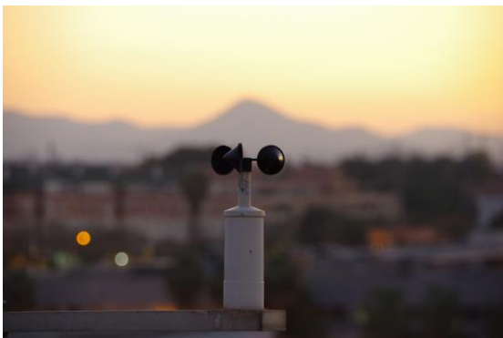
Figura 2: Anemómetro, instrumento para medir la velocidad del viento. Autor: Julio Solís García
