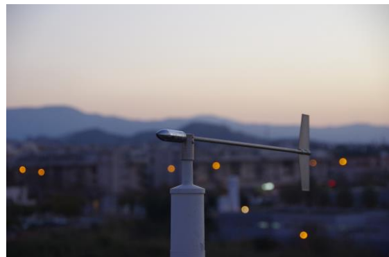
Figura 3: Veleta, instrumento para medir la dirección del viento. Autor: Julio Solís García
