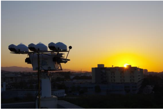
Figura 6: Estación radiométrica tipo (radiómetros, pirgeómetro, pirheliómetro y seguidor solar). Autor: Julio Solís García
